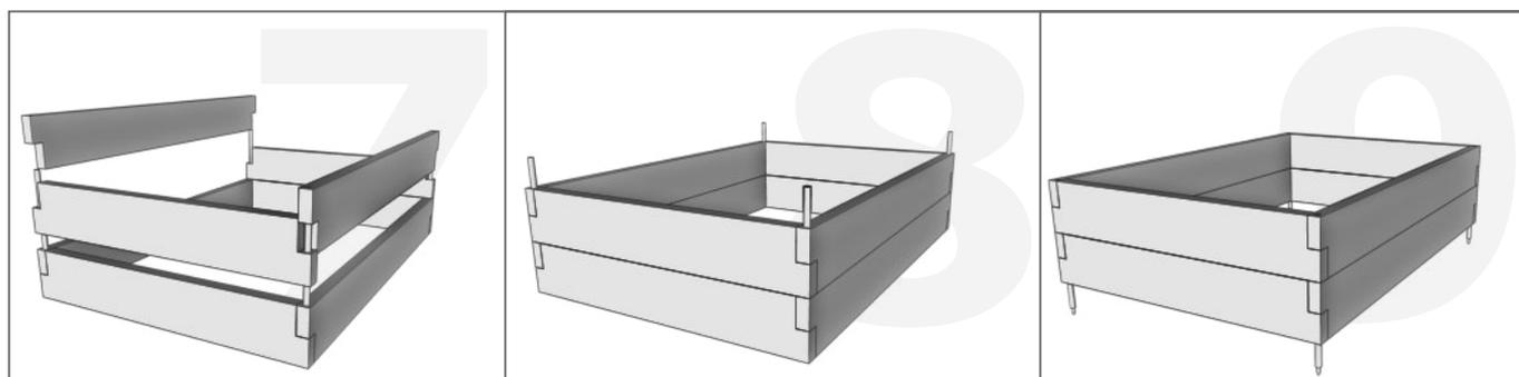
По окончании сборки равномерно заглубите штыри-колышки в землю (Рис. 9). Грядка установлена и зафиксирована на грунте.
