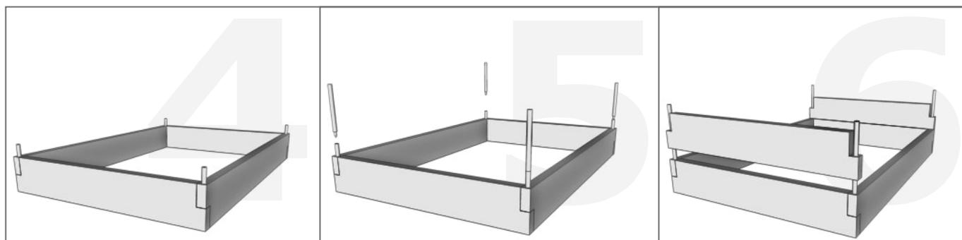
При установке следующего уровня грядки сначала по углам установите следующие 4 штыря таким образом, чтобы острый конец каждого штыря совместился с отверстием нижнего штыря. Предварительно утопите собранные штыри на 3-4 см. Далее устанавливайте бордюры в последовательности указанной выше (Рис. 5-6-7)
