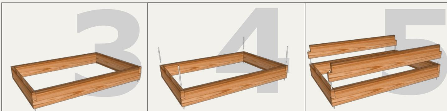
При установке следующего уровня грядки сначала по углам установите следующие 4 штыря таким образом, чтобы острый конец каждого штыря совпал с отверстием нижнего штыря. Предварительно утопите собранные штыри на 3-4 см. Далее устанавливайте бордюры в последовательности указанной выше (Рис. 4-5-6)
